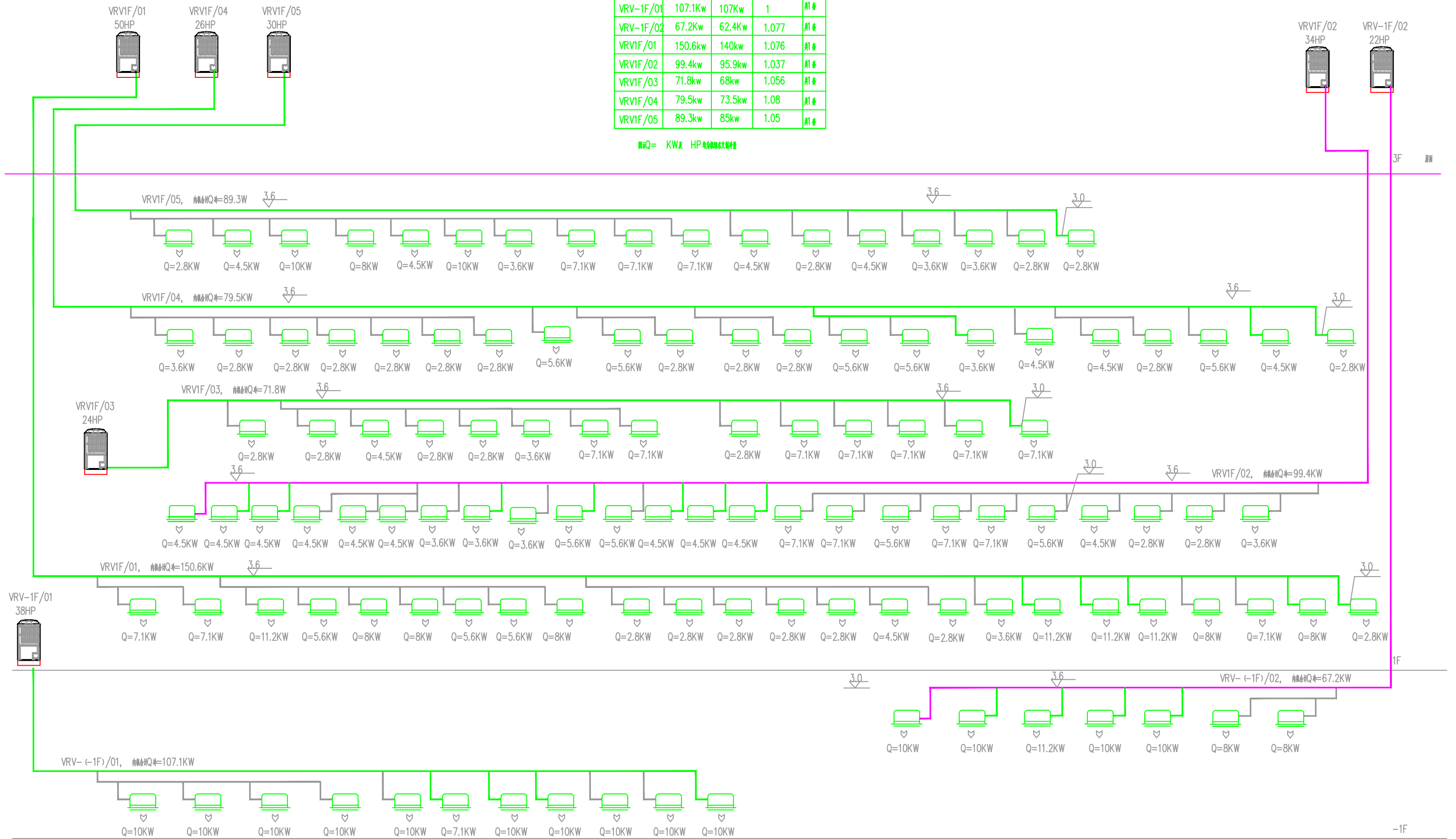
变频多联机空调系统流程图
